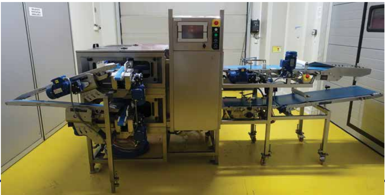
Automatska linija za savijanje/motanje bureka/pita Herkules
