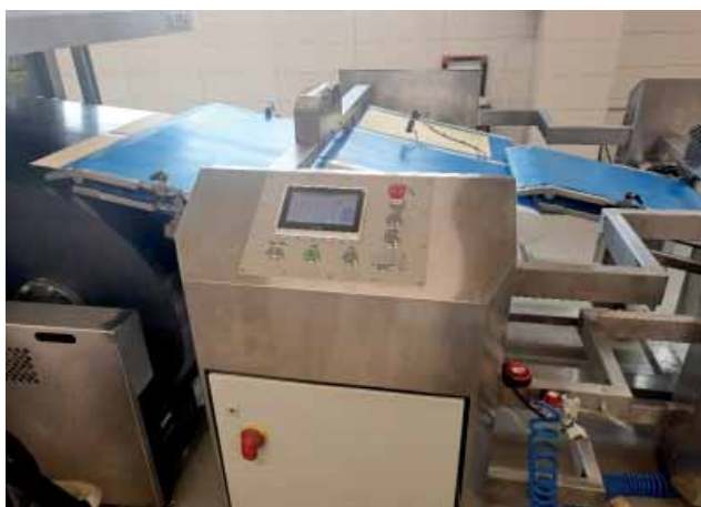
Detalji novoga sustava za odlaganje kora na traku tunelske peći
