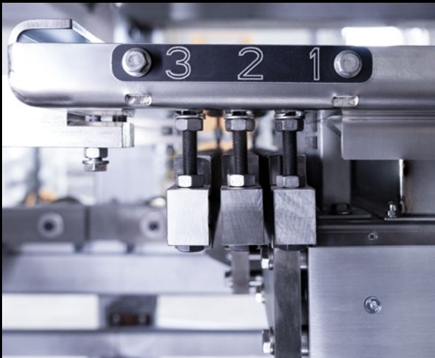
Tri električna induktora omogućuju preciznu kontrolu temperature za svaku pojedinu ploču za pečenje
