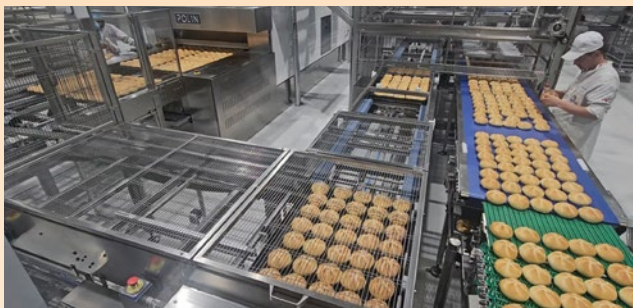
Izlaz proizvoda iz tunelske peći, automatsko vađenje proizvoda s limova i prebacivanje na traku spirale za hlađenje
