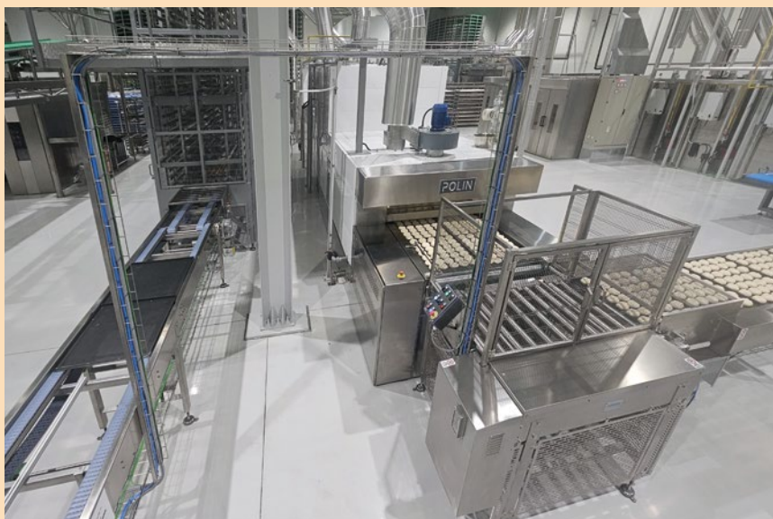
Desno ulaz peciva u tunelsku peć, a lijevo izlaz limova iz tornja za hlađenje koji onda idu natrag na liniju za punjenje tjestanih komada
