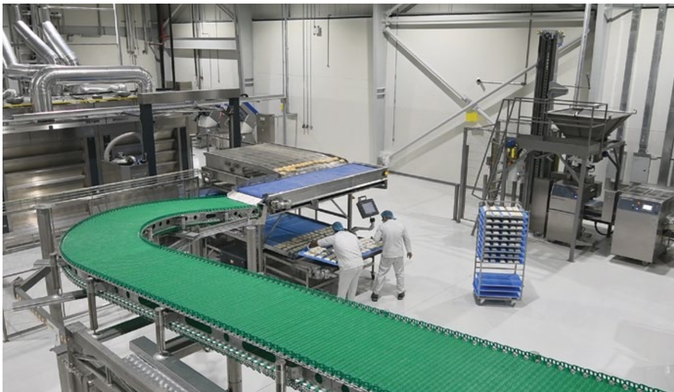
Izlaz polupečenih ciabatta iz peći i prelazak na traku spirale za ambijentalno hlađenje
