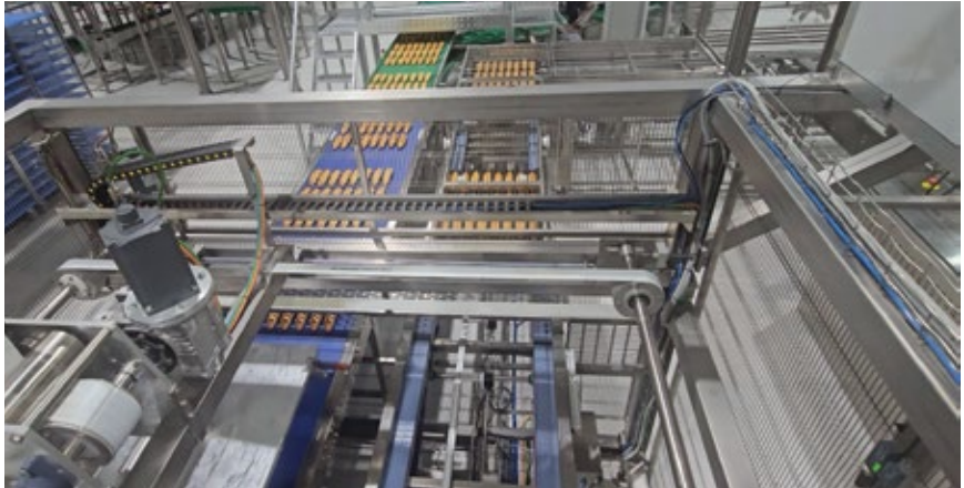
Depaner na liniji za peciva za vađenje proizvoda iz limova na traku spirale za hlađenje
