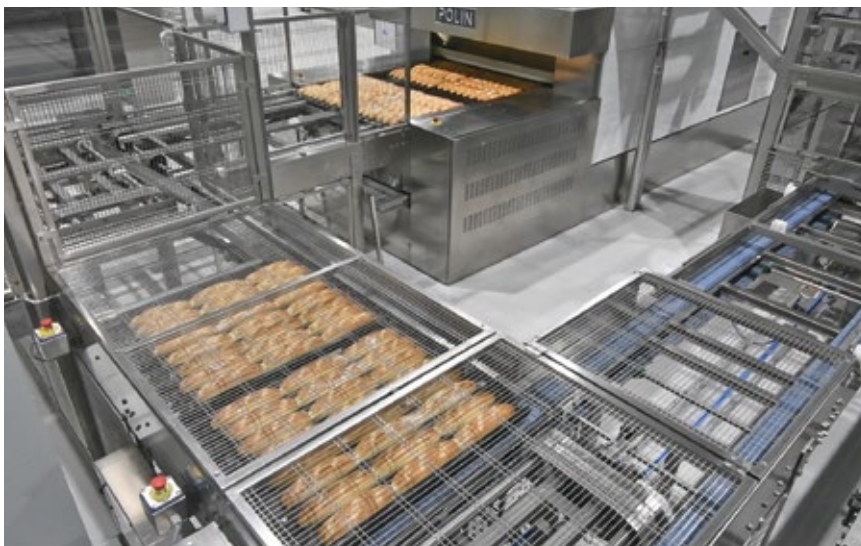
Izlaz pečenih hot-dog peciva (tzv. samoli) iz tunelske peći
