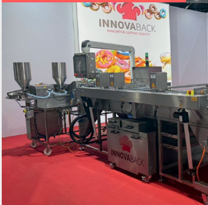
Protočna friteza FG 8-20, 8-redna proizvodnja, kapacitet 1.600 kom/h pri vremenu prženja od 6 minuta
