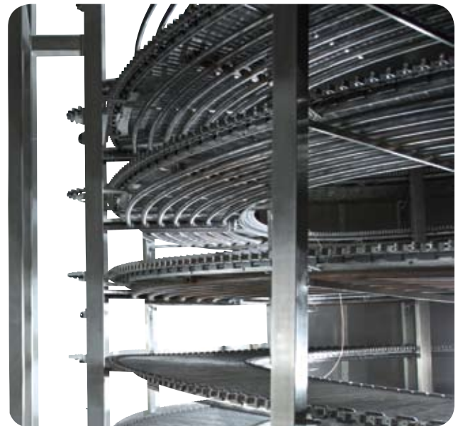
Pogled izbliza na spiralne cijevi peći
