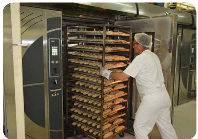
Detalj ubacivanja kolica s proizvodima u peć
