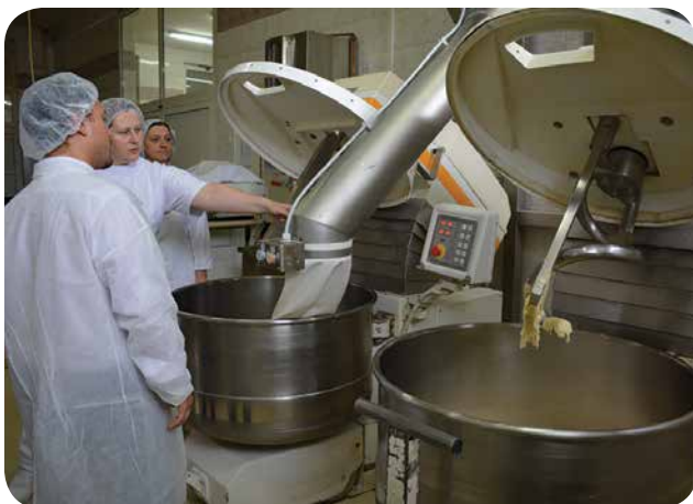
Prikaz cijevi kojom se brašno iz silosa dozira u posude za zamjes
