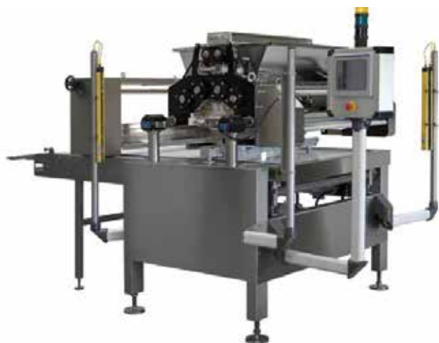
V60 - sustav za doziranje, ekstrudiranje i rezanje žicom
