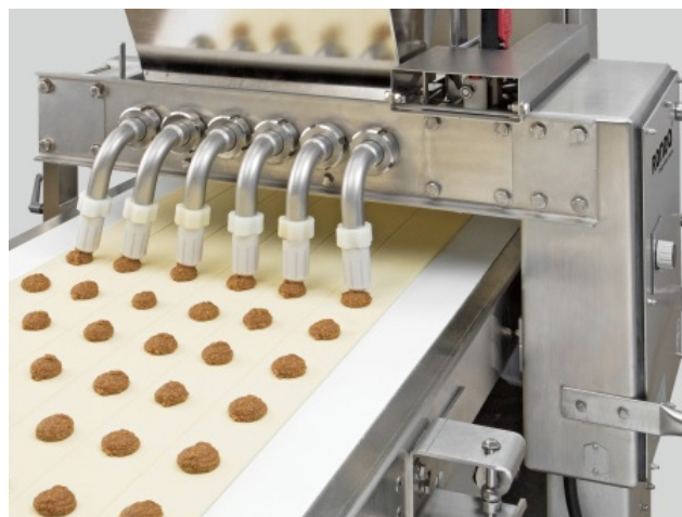
Pneumatska punilica za 6 redova proizvodnje
