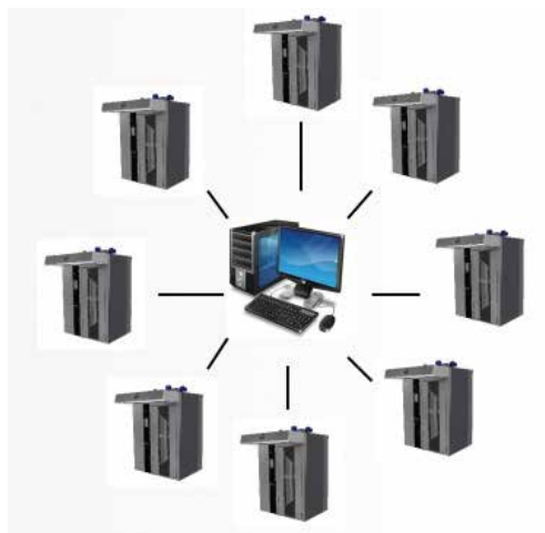
Povezivanje peći s centralnim računalom osigurava praćenje rada peći, alarma i potrošnje energenata
