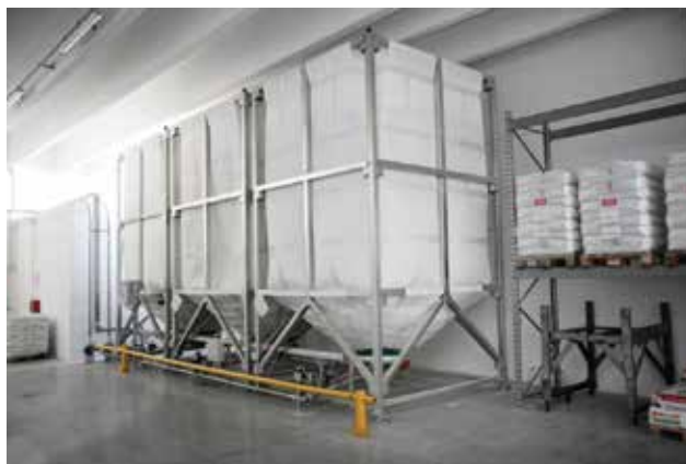
TREVIRA tkanina osigurava cirkulaciju zraka i slobodan protok uskladištene tvari
