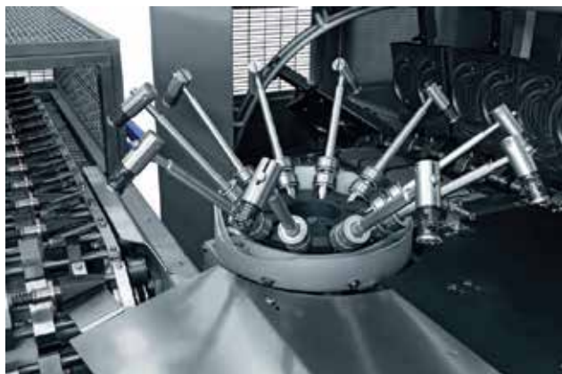
Nakon pečenja, posebni rotirajući sustav skida vruće i savitljive vafle s ploča i ubacuje ih u naprave za rolanje koje ih oblikuju u kornete
